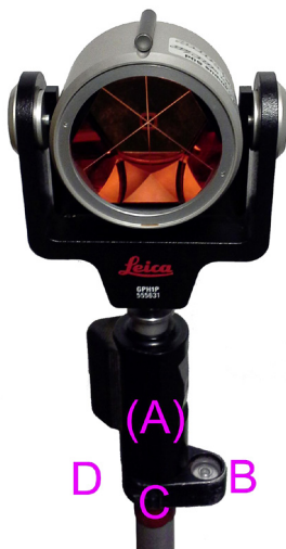
Abb. 17: Verdrehung des Prismenstabs
