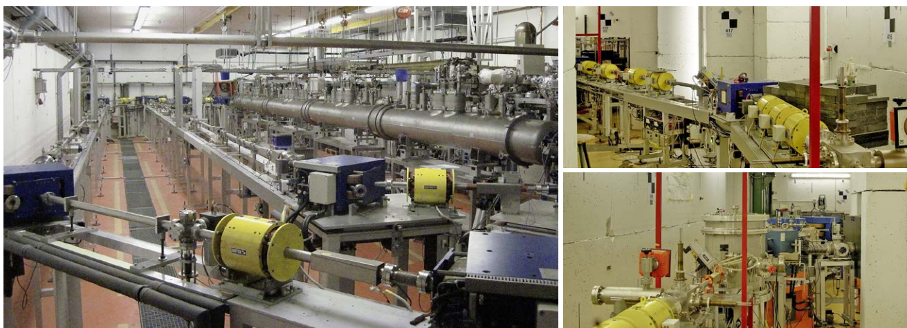
Abb. 2: S-DALINAC Strahlführung in der Beschleunigerhalle (links), verwinklelter Bunkerbereich der Experimentierhalle (rechts)
