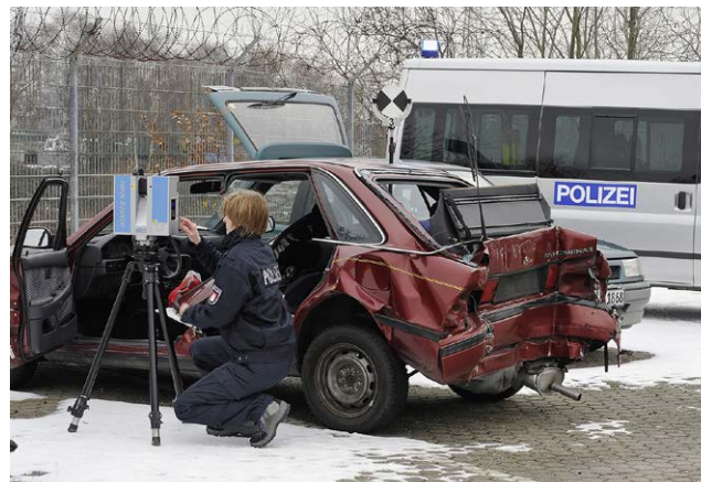
Abb. 1: 3D-Laserscanner im Einsatz
