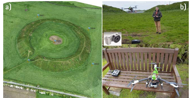
Abb. 10: a) Ringwallanlage Lembecksburg inkl. Passpunkt-lage aus der Vogelperspektive, b) Hexakopter Sky Hero Spy 750 mit Steuereinheit 3D Robotics Pixhawk und Kamera Sony Nex-5 im Einsatz
