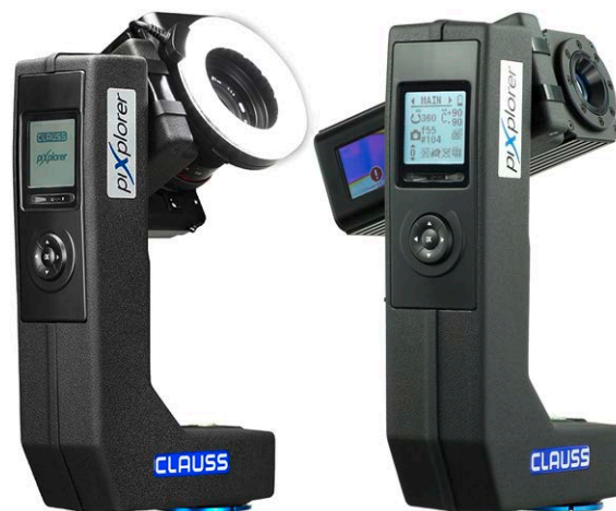
Abb. 1: Links piXplorer 500 und rechts der Prototyp des ThermoHead 25. Beide Systeme nehmen per Knopfdruck vollständige 360^\circ \times 180^\circ -Panoramen innerhalb von 5 Minuten auf. Der piXplorer 500 erstellt ein RGB-Panorama mit 500 Megapixeln Auflösung, der ThermoHead ein 25 Megapixel-Thermografiepanorama. Durch die geometrische Kalibrierung der Kameras sind beide Panoramen verzerrungsfrei.
