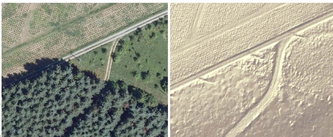
Abb. 5: Auswertbare Bereiche für die Bildung von Sollkoordinaten anhand eines digitalen Orthophotos und eines hochauflösenden Digitalen Geländemodells
