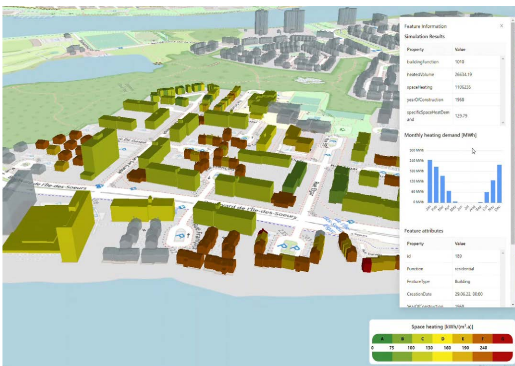
Abb. 7: Wärmebedarfs- simulation über die OGC API – Processes verbunden mit der SimStadt API
